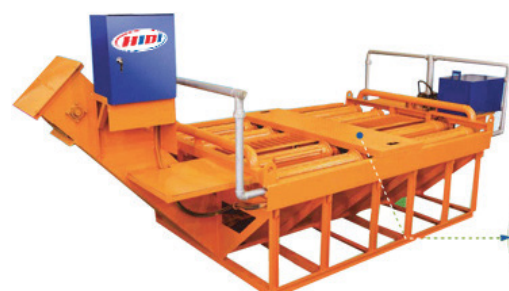
Máy rửa xe công trình tự động THƯƠNG HIỆU HIDI - HÀN QUỐC Tải trọng xe: 10 - 25 tấn Công suất rửa: 640 xe/ngày Thời gian rửa: 45 giây/xe HTWA1100, HTWA2410 HTWA2500, HTWA3100
