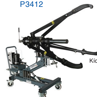
Cảo thủy lực 50 tấn di động PME50TE
